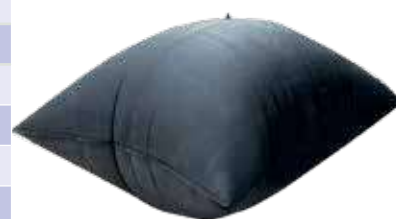
Mise à l'épreuve d'une citerne souple Epdm par gonflage d'air
